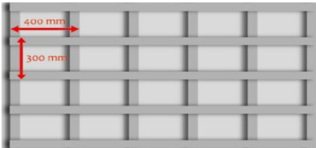
Plaatsing regels en tengels bij verticale montage
